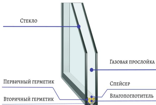
Рис. 1. Геометрия однокамерного стеклопакета
