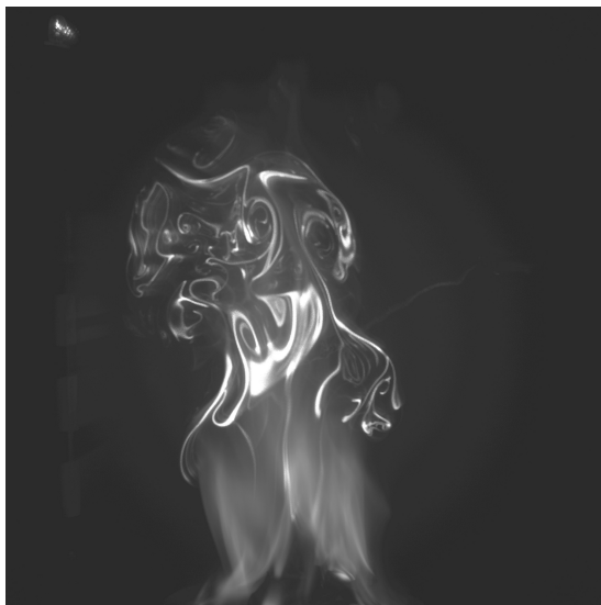
Рис. 1. PIV-фотография потока в пламени (древесина кедра)
